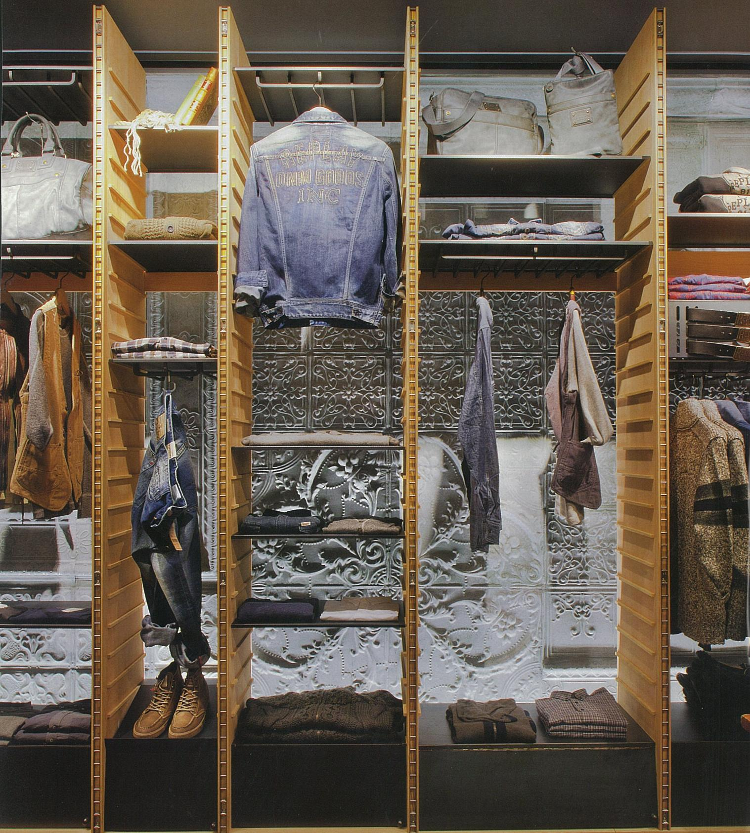
壁面什器には、米松材と黒皮鋼板を使用。幅や高さに自由度を持たせることで多彩な商品に対応
